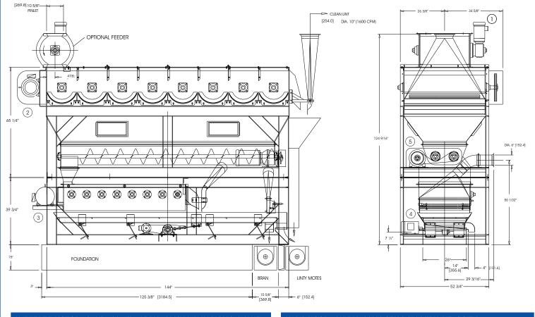
FEEDER MOTOR - 1.5HP - 1450/1750RPM - 380/230-460V / 3PH / 50-60HZ
